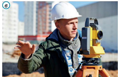
Мал. 58. Прилади для визначення відносної висоти точок: а – шкільний нівелір; б – оптичний нівелір з рейкою; в – теодоліт
