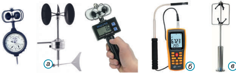
Мал. 176. Анемометри різної конструкції: а – чашкові (механічний та електронні); б – тепловий; в – тривимірний ультразвуковий
